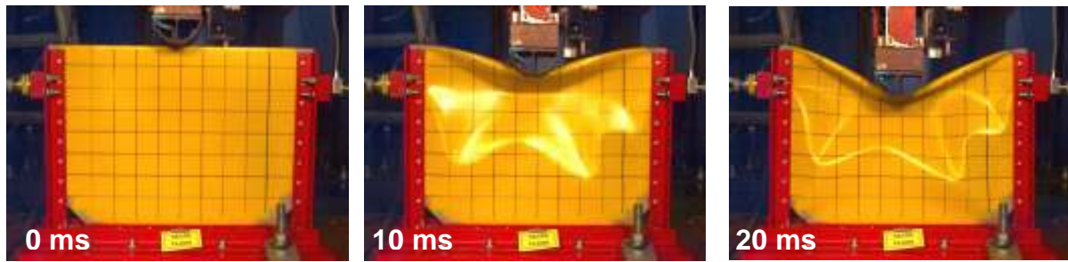
Abb. 1: Untersuchung von Bodenblechvarianten im Komponententest
